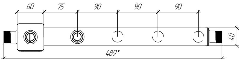
\* Используется для разметки отверстий кронштейнов
