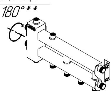
\*\* Для верхней подводки потребителей допускается перевернуть коллектор на 180° по горизонтальной оси
